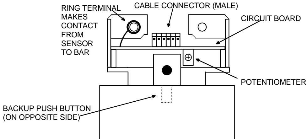
**3.7 USE OF REDUNDANT (BACKUP) SWITCH AND LABELS**
